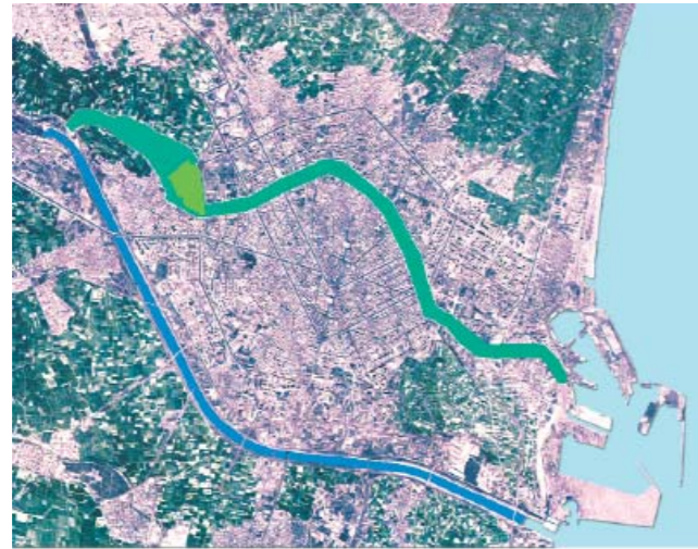
■ Nou llit artificial del riu Túria (1969) ■ Parc metropolità del Túria. Extensió = 230 Ha. ■ Parc de Capçalera. Extensió = 35 Ha.
