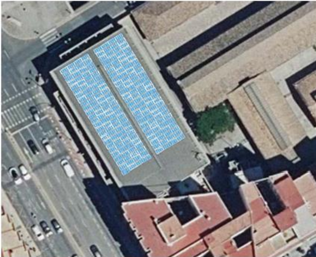
Piscina del Complex Esportiu-Cultural Petxina disposició dels panells solars:
